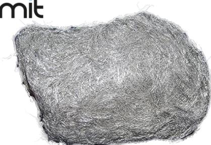
**Aluminium-Hanf verbessert die Stabilität der Gewindeverbindung unter Druck und dichtet zusammen mit der Grafitpaste NIVO das Gewinde ab.**
